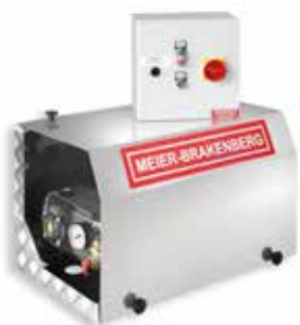
MBHST 2400: Vysokotlaké stacionární mycí zařízení MBHST 2400 poskytuje hodinový průtok 2 400 litrů vody o teplotě až 80 °C
